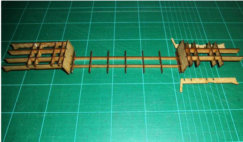
Die Pufferbohle wird aufgeklebt und gedoppelt mit Verstärkungsplatte für die Puffer. Auch die Drehzapfenteil wird eingeklebt.
